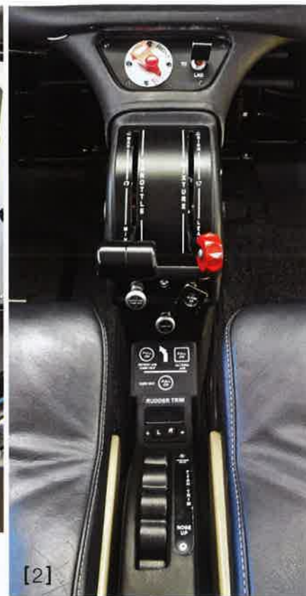
[1] Die beiden großen Bildschirme des G1000-Systems beherrschen das Panel. Mit der G1000-Ausstattung ist die Tecnam auch für IFR-Flüge bei Tag und VFR-Flüge bei Nacht zugelassen. Das Cockpit gibt es auch mit weniger komplexer Ausstattung. [2] Leistungshebel und Mixer sitzen auf einer kurzen Mittelkonsole.
