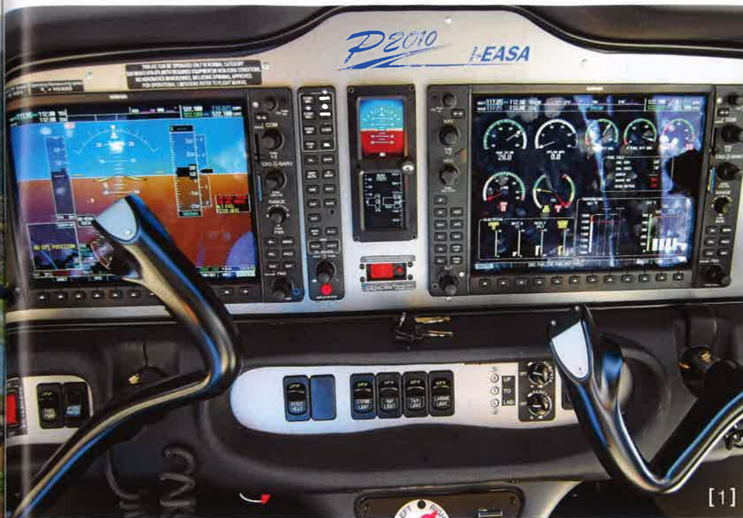
[1] Die beiden großen Bildschirme des G1000-Systems beherrschen das Panel. Mit der G1000-Ausstattung ist die Tecnam auch für IFR-Flüge bei Tag und VFR-Flüge bei Nacht zugelassen. Das Cockpit gibt es auch mit weniger komplexer Ausstattung. [2] Leistungshebel und Mixer sitzen auf einer kurzen Mittelkonsole.
