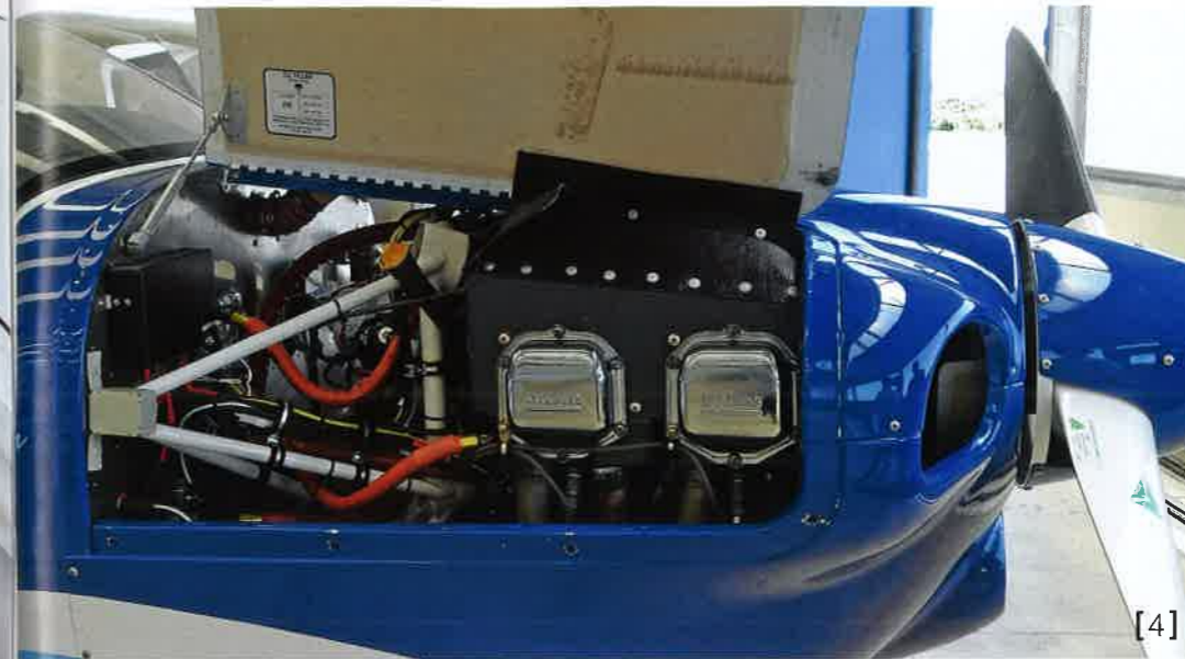
[4] Unter der Haube arbeitet ein Lycoming IO-360-M1A mit 180 PS, der auch mit Mogas betrieben werden kann. [5] Griffbereit, aber nicht im Weg: der Feuerlöscher. [6] Die P2010 ist aus Aluminium und Karbon aufgebaut. Leer wiegt sie nur 710 kg.
